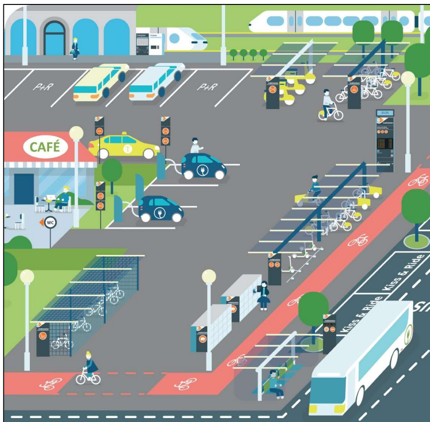
Abbildung 30: Prinzip-Darstellung zur Funktionalität einer Mobilstation, Quelle NVR.
